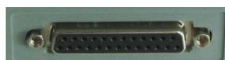
Złącze RS232 w panelu sterującym do drukarki lub komunikacji z komputerem ( należy wybrać jedną z tych opcji)
